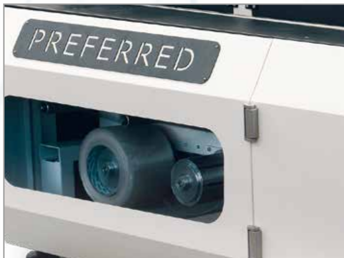
Podwójny uchwyt mocujący bobinę z taśmą klejącą.
