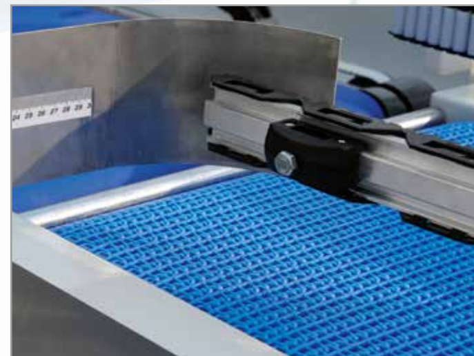
Taśma Intralox i koło zamachowe ułatwiające szybką zmianę formatu przy pomocy linijek mierniczych.
